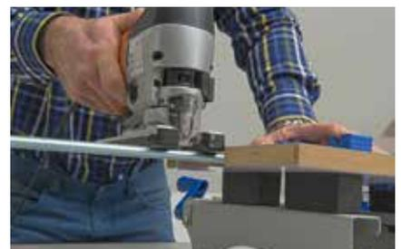
**9.** Die Gewindestangen für die zusätzliche Verbindung der Seitenteile einzeln ablängen. Hierfür ein Metallsägeblatt einsetzen.
