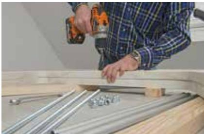
**11.** Damit die Bohrungen für die Gewindestäbe deckungsgleich sind, die beiden Seitenteile exakt übereinanderlegen und mit Zwingen fixieren. Holzklötze unterlegen!
