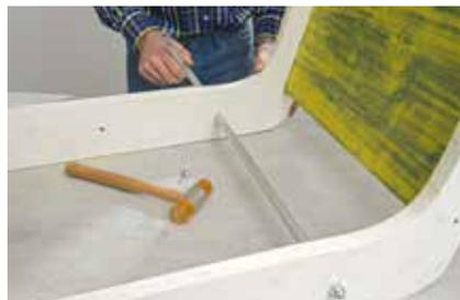
**16.** Auf die überstehenden Enden der Gewindestangen Hutmuttern schrauben. Damit sich diese nicht ins Holz drücken, Unterlegscheiben einfügen.
