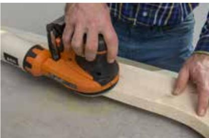
**7.** Anschließend die Kanten mit einem Schleifgerät oder per Hand brechen und die Flächen mit mittlerem und feinem Schleifpapier glätten.
