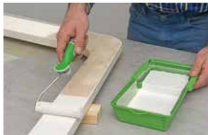
**8.** Für die Seitenteile wurde hier Dekorwachs, Farbton „Seide“ verwendet. Beide Seitenteile streichen. Wird ein stärker deckender Anstrich gewünscht, einen zweiten Auftrag vornehmen.
