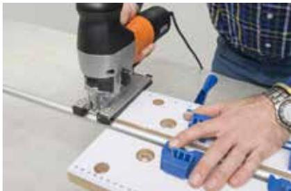
**10.** Die vier Alurohre als Abdeckung für die Gewindestangen werden in einer Länge von 50 cm zugeschnitten.
