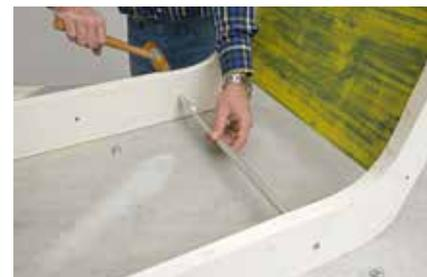
**15.** Die Gewindestangen durch beide Seitenteile stecken und dabei die Alurohre für die Abdeckung im Mittelteil nicht vergessen. Eventuell mit einem Gummihammer nachhelfen.
