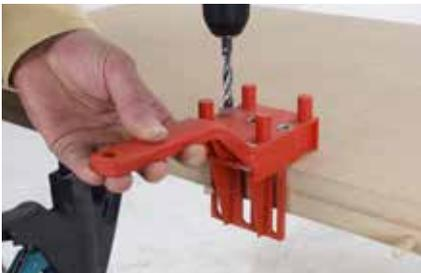
**10.** Dübel mit Holzleim einleimen, Dübellöhre überstülpen und Abstandsmesser einstellen. Legen Sie Boden und Rand übereinander und fixieren Sie sie. Dann einfach Dübellöhre ansetzen und das Gegenloch in die Bodenplatte bohren.
