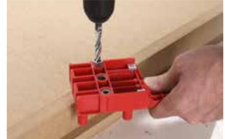
**9.** Um die Längs- und Querleisten mit der Bodenplatte zu verbinden, bohren Sie zunächst 8er- oder 10er-Dübellöcher in die untere Schnittkante. Dübellöhre oder Dübelmarkierer benutzen.
