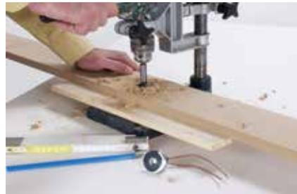
**2.** Für die Spots in die unteren Laufleisten Löcher bohren (mit dem Forstnerbohrer) oder sägen (mit der Lochsäge). Mit einem Bohrständler gelangen gerade Löcher. Die Lochgröße richtet sich nach den Spots.
