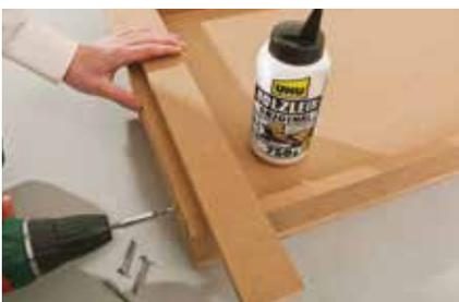
**13.** Die Rollenbefestigungsleiste mit dem kurzen Stück nach unten auf den Rollboden einlegen. Etwas Leim eingeben und zusätzlich verschrauben.
