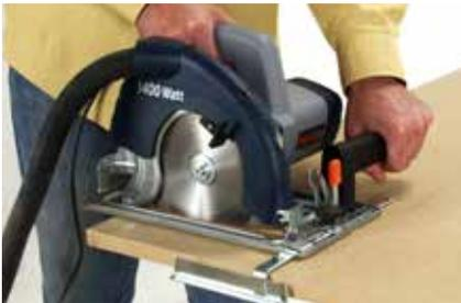
**1.** Die Leisten mit der Handkreissäge mit Parallelanschlag auf die angegebene Breite schneiden. Beim Zusägen auf die benötigte Länge die Führungsschiene verwenden oder zur Kapp- und Gehrungssäge greifen.
