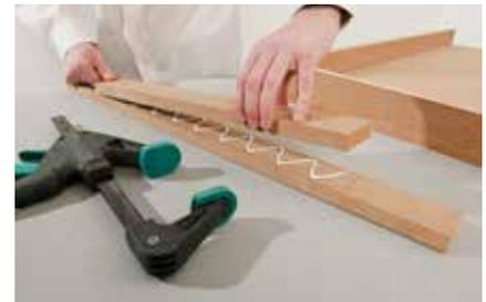
**12.** Montageleisten für die Bockrollen mit der Aufdopplung verleimen. Der Überstand ist von der Größe der Bockrollen abhängig. Die Länge der Aufdopplung (die kürzere Leiste) entspricht dem Innenmaß des Rollbodens.
