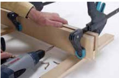
**4.** Die drei Teile zusammenfügen, mit Zwingen fixieren und verschrauben. MDF reißt schnell, unbedingt vorbohren!
