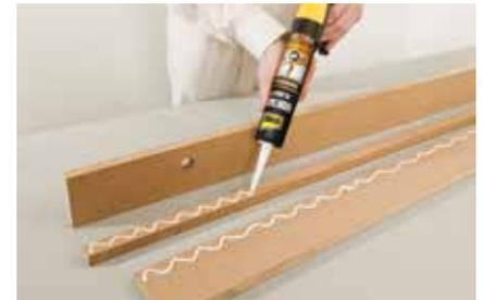
**3.** Die Laufleisten verleimen: Das obere und untere Brett mit einer Zwischenleiste verbinden. Montagekleber wellenartig über die gesamte Leistenbreite und -länge verteilen.
