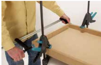
**11.** Bringen Sie die Längs- und Querleisten rundherum mit Holzleim an. Damit während der Abbindezeit des Leims nichts verrutscht, fixieren Sie alles mit Schraubzwingen.
