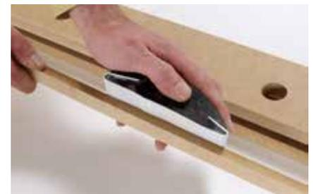
**6.** Alle Oberflächen abschleifen und Kanten brechen, auch an den beiden weiteren Zwischenleisten, die später die Kabel verdecken. Dann den Lack auftragen.
