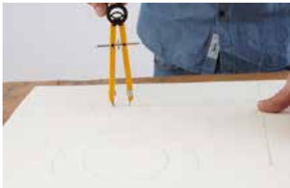
**1.** Zeichnen Sie die Ringe mit dem Zirkel auf die Multiplexplatte. Der erste Ring hat einen Außendurchmesser von 10 cm und einen Innendurchmesser, der zur Lampenfassung passt. Der zweite Ring hat einen Außendurchmesser von 14 cm und einen Innendurchmesser von 8 cm.
