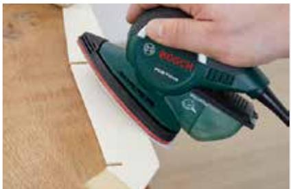
**4.** Mit dem Multischleifer die Sägeschnitte vorsichtig glatt schleifen. Dazu befestigen Sie die Lamellen vorher am besten mit Schraubzwingen an der Werkbank.
