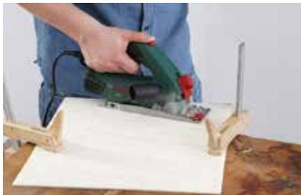
**2.** Schneiden Sie die Schablone für die Lamellen aus und übertragen Sie diese 20-mal auf die Multiplexplatte.
