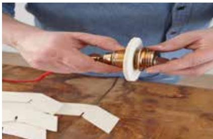
**5.** Verbinden Sie die Lampenfassung mit dem oberen Ring. Entscheiden Sie sich für eine LED-Lampe, da das Leuchtmittel nicht so heiß wird und somit problemlos in Kombination mit Holz verwendet werden kann.
