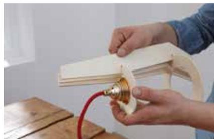
**6.** Geben Sie etwas Holzleim in die Schlitzte der Lamellen und stecken Sie die Lamellen im Abstand von 1 cm auf beide Ringe. Der Ring mit der Leuchtenfassung kommt nach oben, der größere Ring nach unten. Kleben Sie fünf bis zehn Lamellen nicht fest, sondern stecken Sie sie nur locker auf die Lampe, dann können Sie sie später abnehmen, wenn das Leuchtmittel ausgetauscht werden muss. Markieren Sie sie eventuell unauffällig.
