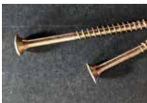
*Tipp: Senkkopfschrauben mit Teilgewinde ziehen zwei Werkstücke besser zusammen als Schrauben, deren Gewinde über den ganzen Schaft läuft.*
