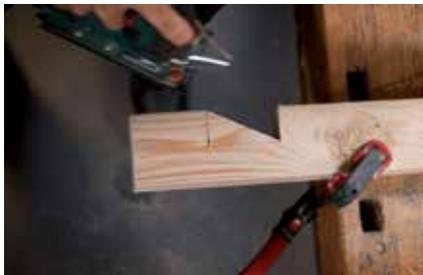
**2.** Der mittlere Balken der Pfosten wird im unteren Bereich ausgeklinkt, also mit einer Aussparung versehen. Hier werden die Querhölzer, welche die Pfosten später verbinden, eingefügt. Mit der Stichsäge die Aussparungen Stück für Stück aussägen.
