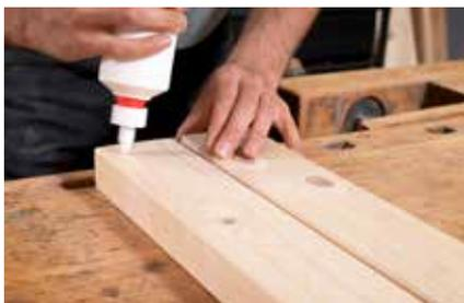
**7.** So verleimen, wie zuvor die Pfosten für die Hantelablage: Die Hölzer mit Leim und unter dem Druck von Schraubzwingen verbinden. Zusätzlich verschrauben.
