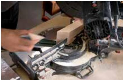
**1.** Zunächst die beiden Pfosten für die Hantelablage fertigen. Vier der Hölzer für die Stangenablage werden mit Hilfe der Kappsäge an den oberen Enden abgeschragt.
