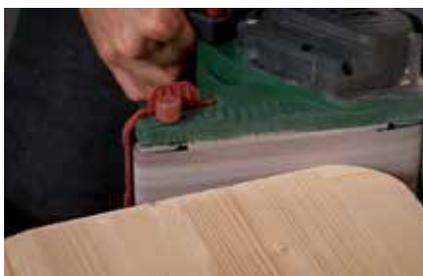
**14.** Rundungen mit der Stichsäge zuschneiden. Rundung schleifen und Kanten brechen.
