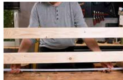
**12.** Die Pfosten der Hantelablage verbinden. Die Verbindungsstücke jeweils in die Ausklinkungen stecken. Parallelität und Abstände messen. Die Verbindungsstücke von außen an den Pfosten anschrauben.
