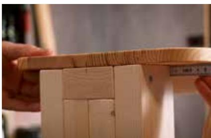
**16.** Verbindungstraverse oben auf die Fußteile bündig auflegen. Vorsichtig einklopfen und von oben anschrauben. Die Liegefläche auflegen, vermitteln, anzeichnen. Liegefläche wieder abnehmen. Die Löcher in der Traverse vorbohren, damit, wenn die Liegefläche von unten festgeschraubt wird, die Schrauben auch gut in der dünnen Liegefläche anziehen.
