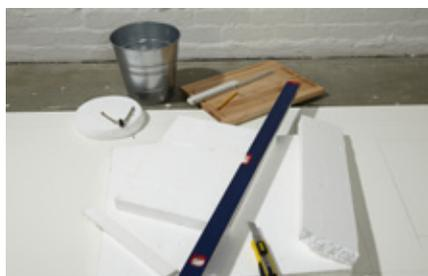
4. Alle Aussparungen für den Grill, das Schneidebrett und den Getränkekühler werden aus Styropor geschnitten.
