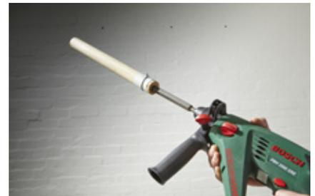
**15.** Um den Beton wirklich gleichmäßig zu verteilen, kann aus Schlagbohrmaschine, Rundholz und einem Meißel ein behelfsmäßiger Betonrüttler konstruiert werden. Wichtig: Die Drehung ausschalten und nur den Schlag anlassen!
