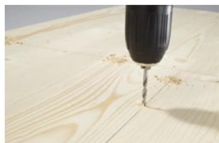
**6.** Alle Verschraubungen vorbohren. Zusätzliches Ansenken entfernt die Bohrspäne und die Schrauben sitzen später schön flächenbündig.
