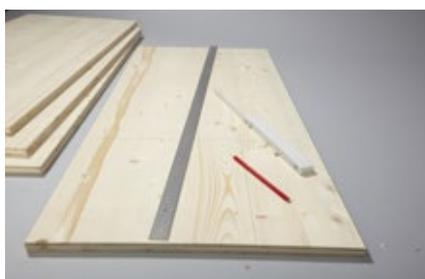
**5.** Die Bauteile für den Korpus vorbereiten: Verschraubungen anzeichnen.
