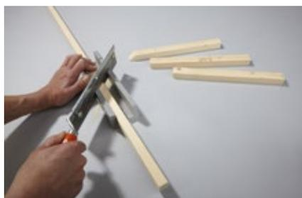
**7.** Die Auflageleisten für die Regalböden im Winkel von 45 Grad zusägen. Eine Gehrungslade leistet hier gute Dienste.
