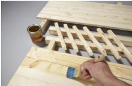
**10.** Alle Teile mit Nadelholz-Imprägnierung behandeln.
