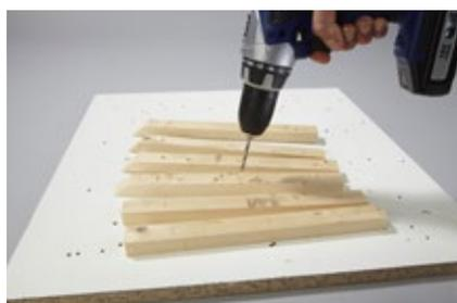
**8.** Die Leisten vorbohren, Bohrlöcher ansenken.
