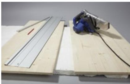
**2.** Tipp: Falls Sie die Platten nicht im Baumarkt zuschneiden lassen, kann eine feste Styroporplatte als gute Unterlage für den Zuschnitt mit Handkreissäge und Führungsschiene dienen.
