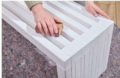
**14.** Nach Trocknung mit feinem Schleifpapier (Körnung 240) zwischenschleifen.
