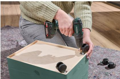
**16.** Die Kisten ebenfalls grundieren und zweifach lackieren. Rollen unterschrauben. Je nach Dicke des Bodens muss dieser mit einem Brett aufgedoppelt werden, so dass die Schrauben greifen und die Spitze nicht am Kistenboden durchsticht.
