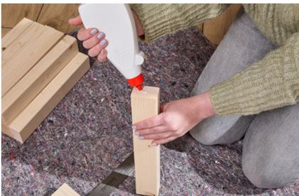
**4. Die Hölzer** werden in einer bestimmten Reihenfolge geleimt und verschraubt. Den Start machen ein langes und ein kurzes Holz (Querschnitt 40x60 mm). Am kurzen Holz, dem Bein, oben Leim angeben.
