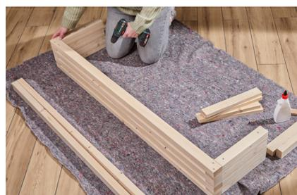
**8. Schritt 4 bis 7** mehrfach wiederholen. Nach diesem Prinzip des „Leisten-Stapelns“ baut sich die Bank auf.
