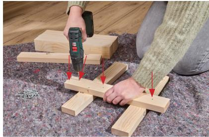
**2. Die schmalere** Konstruktionshölzer (mit Querschnitt 24x60) füllen die Zwischenräume der Beine und sorgen für Stabilität. Die Hölzer im oberen Bereich zweifach vorbohren, zwei weitere Bohrungen weiter unten setzen (siehe Pfeile oben im Bild).
