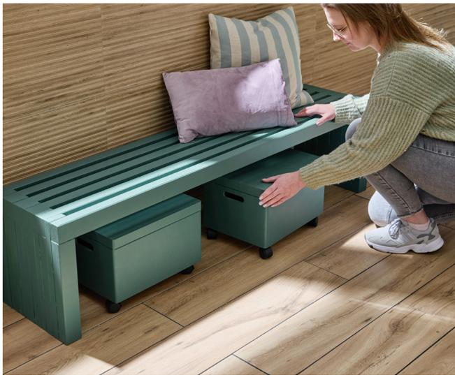
Reduziert gestaltet und einfach zu bauen: Diese Bank besteht aus zahlreichen Konstruktionsleisten, die per Leim und Schrauben Stück für Stück aufeinandergestapelt sind. Im Idealfall kaufen Sie die Konstruktionshölzer fertig zugeschnitten. Dann ist der Zusammenbau einfach und lässt sich mit wenig Werkzeug durchführen.
