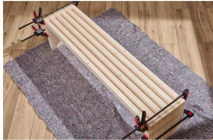
**11.** Die Konstruktion unter dem Druck der Zwingen trocknen lassen.
