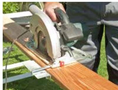
**13.** Die exaktesten Schnitte liefert jedoch eine Handkreissäge mit Anschlag. Das ist vor allem bei Längsschnitten wichtig.
